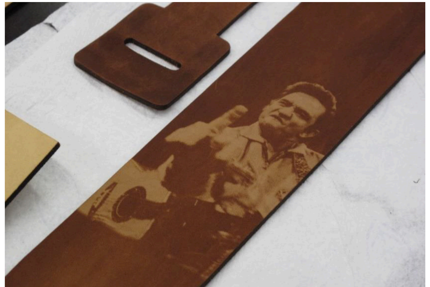
Ein Gitarrengurt geschnitten und graviert (Bild von Jonny Cash) mit dem Laser-Cutter
